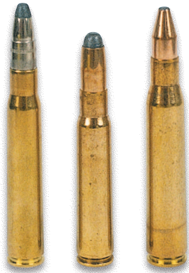
Zum Vergleich von links nach rechts: 8 × 64 S, 8 × 57 IS, 8 × 68 S.
